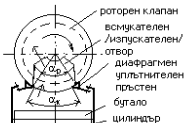
Фиг.3. Диафрагмен уплътнителен пръстен на роторен клапан.
