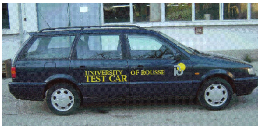
Фиг. 1 Лабораторен автомобил оборудван с навигационна система "VBOX".
