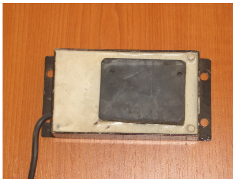
Фигура 2. Сензор за измерване количеството растителна маса постъпващо за овършаване в зърноприбиращ комбайн
