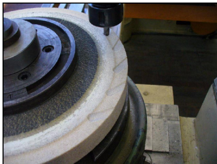
Фиг. 2 Реализация на дискретен диск за профилно шлифование
