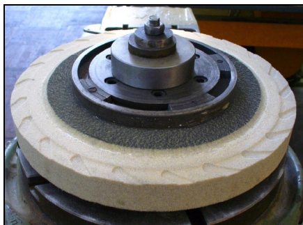
Фиг. 2 Реализация на дискретен диск за профилно шлифование
