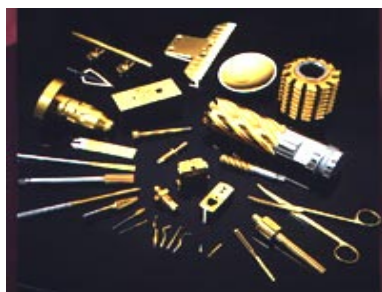
Фиг.5. Инструменти с TiN покритие
