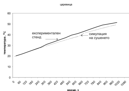
Фиг.4. Графично преставяне на съвпадението на кривите във времето при температура на сушилният агент t_a = 90^\circ \text{C} за един слой зърно
