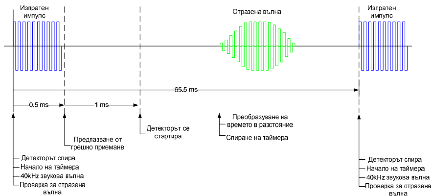
Фиг.3 Схема показваща принципа на работа на блокове приемник и предавател
