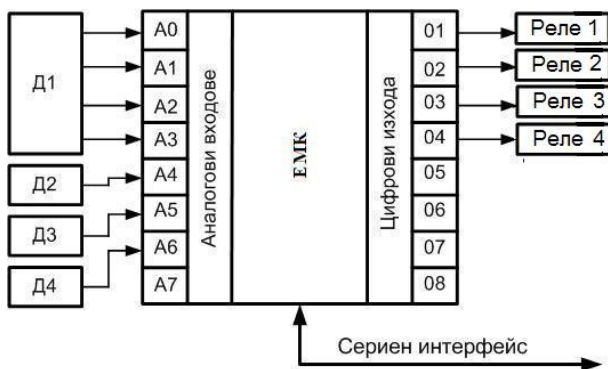
Фиг. 3. Структурна схема на електронна система за автоматично насочване на фотоволтаичен панел
