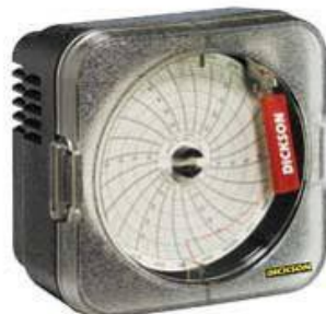
Фиг.2. Общ вид на термограф Dickson SC3
