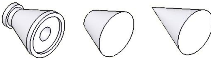
Фиг 1 Детайл, обработван с радиален профилен нож и съставна конична част от него
