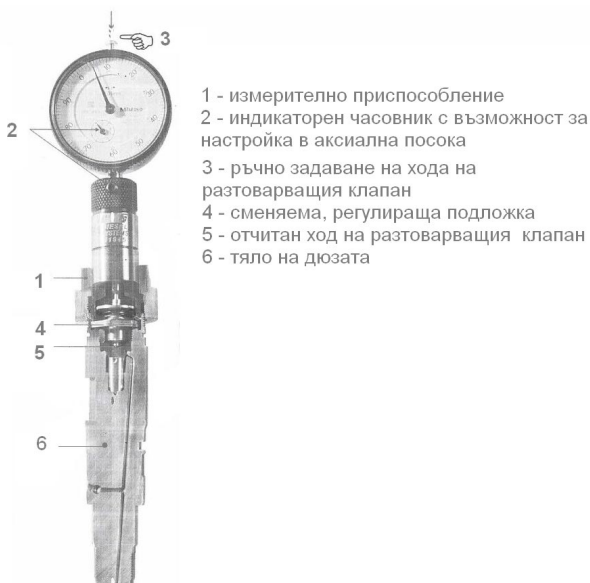
Фиг. 3 Измерителна установка за установяване и регулировка на хода на разтоварващия клапан
