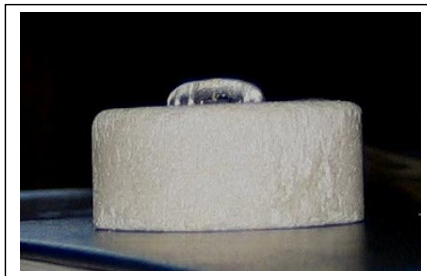
Фиг.3. Фотография на хидрофобно калциево-силициево изделие с лежаща на него водна капка
