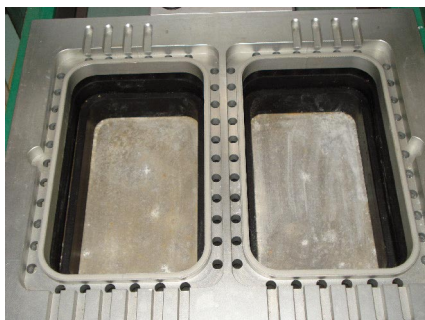
Фиг. 2. Камера на опаковъчната машина с гнезда за опаковките
