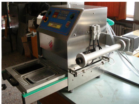
Фиг. 2. Машина за опаковане в модифицирана атмосфера
