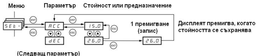
Фиг.4. Програмиране на параметър на ALTIVAR31
