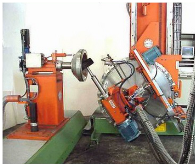
Рис.4 Робот Working Robot 267 на фирмата "SILLEM"-Италия обработва вътрешна сферична повърхнина на изделие от неръждаема стомана
