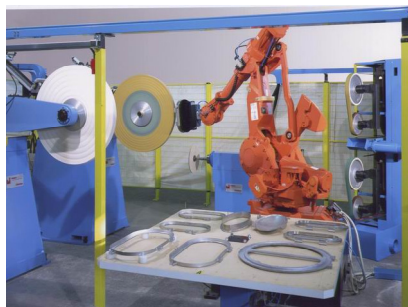
Фиг.2 Използване на робот от фирмата "SILLEM"-Италия за полиране на рамки за корабни люкови закрития.
