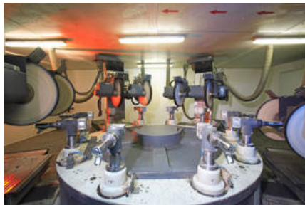
Фиг.5 Агрегатна машина за полиране на фирмата Sunspring America, Inc.- САЩ
