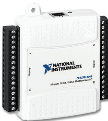
фиг.5 Входноизходен модул NI USB-6009 – общ вид
