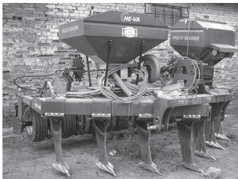
Фиг.3. Схема на дълбокорозрохвач с разпръскване на минерални торове по повърхността на почвата
