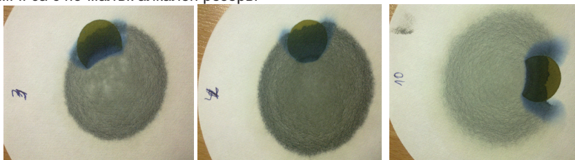
Фиг.8. Проби за алкален резерв на масла сменени след 250 м.ч.
