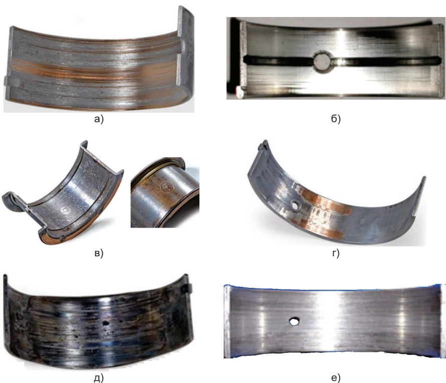
Фиг.4. Дефекти при плъзгащите лагери
