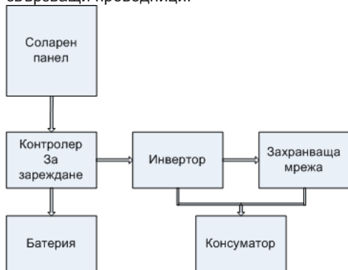
Фиг. 1 Устройство на базова стационарна фотоволтаична система
