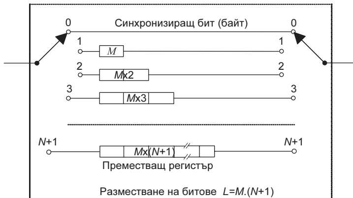
Фиг. 3 – Функционална схема за Разместване на битове във времето
