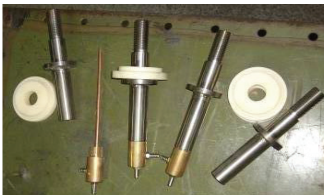
Фиг. 1. Водоохлаждаем токовод за вакуумна пещ – външен вид
