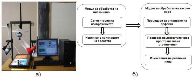
Фиг. 1.Общ вид а) и блок-схема б) на системата за компютърно зрение
