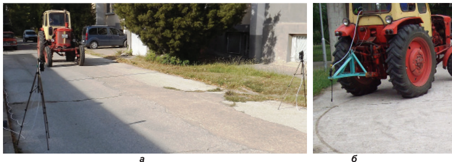
Фиг.3. Измервателна система за изпитване характеристиките на спирачните системи (а) и радиусите на завиване на трактори (б)
