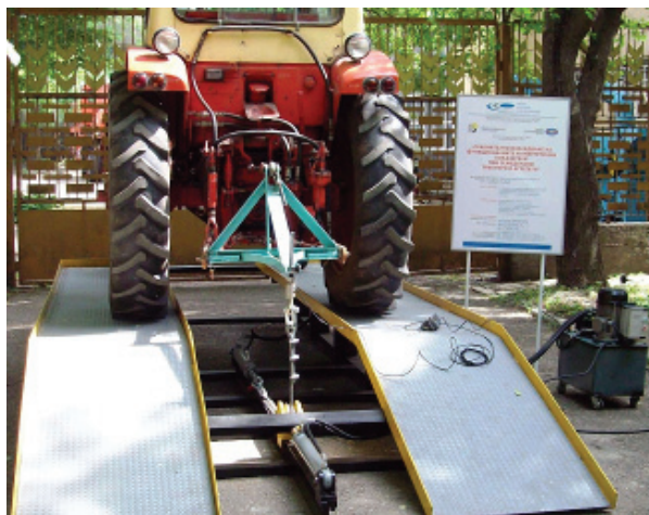
Фиг.4. Стенд за изпитване подемната сила на навесни системи
