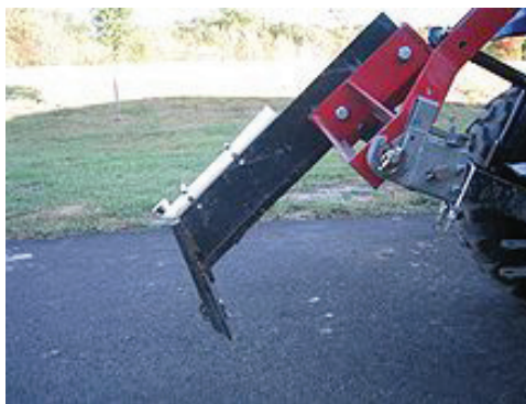
Фиг.6. Дълбокоразрохквач за внасяне на мелиоративни материали в подгорния слой.
