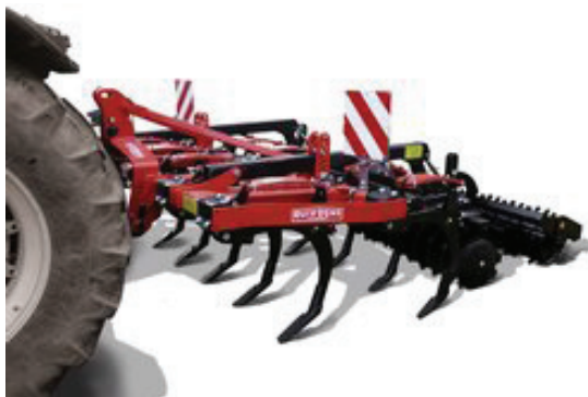
Фиг.4. Дълбокоразрохвач чизел плуг.
