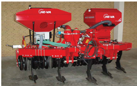
Фиг.5. Схема на дълбоко разрохквач с устройство за разпръскване на минерални торове по повърхността на почвата.
