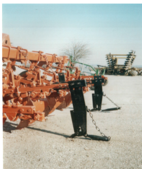
Фиг.5. Общ вид на култиватор КРН 4,2 с устройство за прорязване и ходообразуване.
