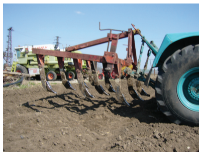
Фиг. 2. Култиватор – разрохквач КРН-2,4.
