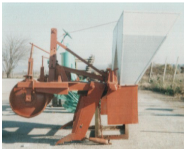
Фиг. 3. Общ вид на преустроен прорезвач-ходообразувател ЩН 2-140, с бункер за мулч.
