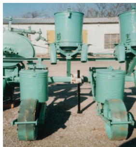
Фиг. 4 Сеялка с прорязващи работни органи.
