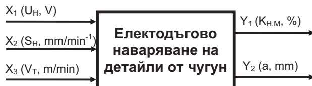
Фиг. 1. Кибернетична схема на обекта на изследване
