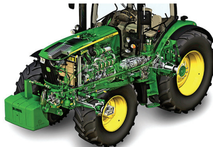
Фиг.6. Представяне на двигателя, трансмисията и ходовата част на трактор с 3D модел
