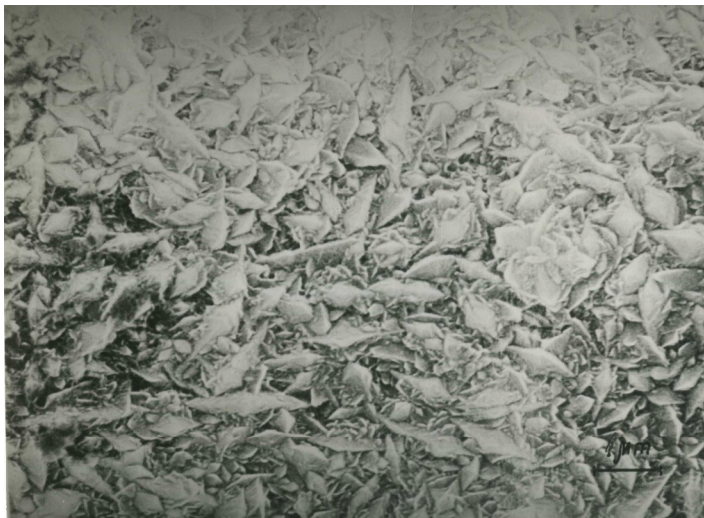
Фиг.2. Електронно-микроскопска снимка на покритието, отложено при: \beta = 2 ; Dk^{cp} = 1,2 \text{ kA/m}^2 ; t_{асум.} = 90 \text{ min} ; T = 353 \text{ K} ; pH = 1,4 . Увеличение: \times 10000
