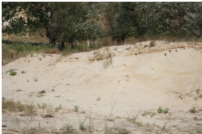
Фиг. 1 Пясък – светлосив до бежово сив, дребно до финозърнест от находище „Дервент”
