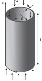
Рис. 5. Цилиндрическая оболочка под действием осевого сжатия
