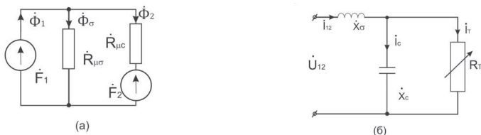
Фиг.3 Еквивалентни магнитна (а) и електрична (б) схеми без шунт
