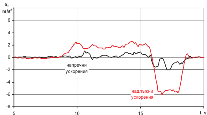
Фиг. 8. Изменение на надлъжните и напречните ускорения в зависимост от времето с плаваща средна стойност по 6 точки
