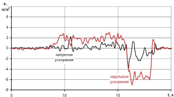
Фиг. 7. Изменение на надлъжните и напречните ускорения в зависимост от времето с плаваща средна стойност по 2 точки
