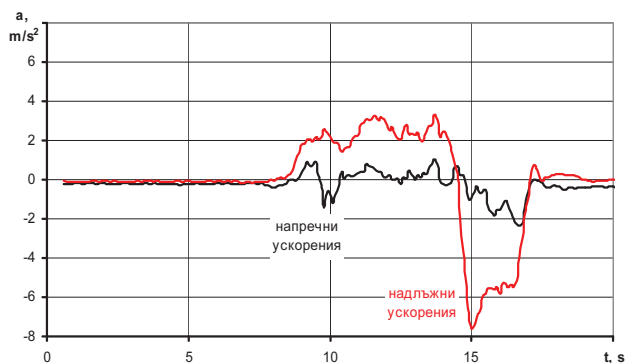
Фиг. 6. Изменение на напречните и надлъжните ускорения в зависимост от времето при налягане на въздуха в гумите 0,15 МПа и двама пътници
