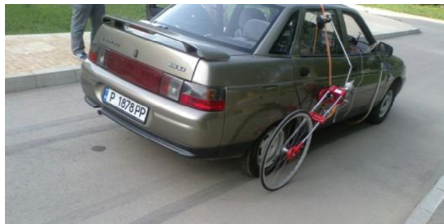
фиг. 2. Система за изследване на спирачните свойства с пътеизмервателно колело монтирана към изпитвания автомобил
