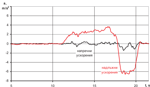
Фиг. 4. Изменение на напречните и надлъжните ускорения в зависимост от времето при налягане на въздуха в гумите 0,25 МРa и двама пътници
