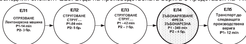
Фиг.1. Производствена верига линеен тип от пет елемента
