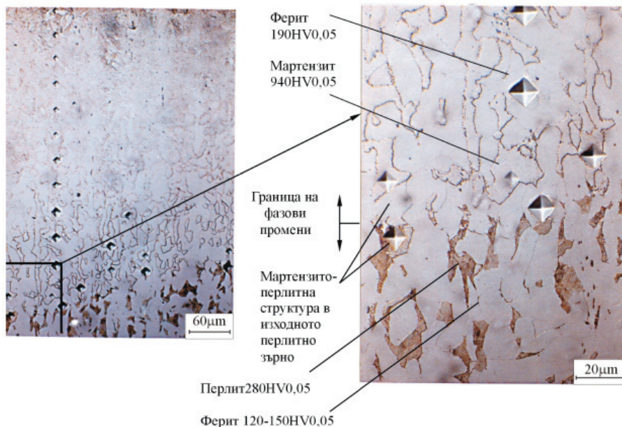
Фигура 1 Микроструктура след ПДВ на стомана 15 по границата на фазови промени
