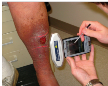
Фиг. 9 – SilhouetteMobile – PDA устройство с модул за структурирана светлина [12]
