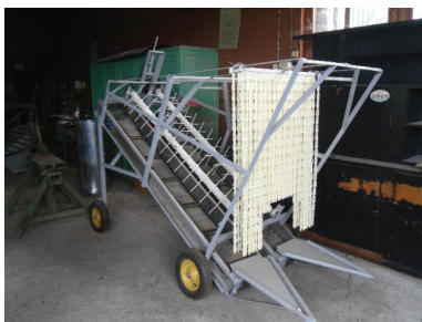
Фиг.3. Прототип на машина за очесване на сусамени кутийки, разработена в Аграрен университет гр. Пловдив
