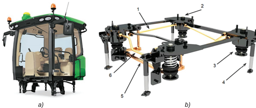
Фиг. 6. Системи за погасяване вибрациите на тракторите [18]: а – кабина на трактор с независимо
