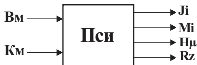
Фиг.1. Модел за изследване процеса на сработване на триещи се повърхности при плъзгане:
