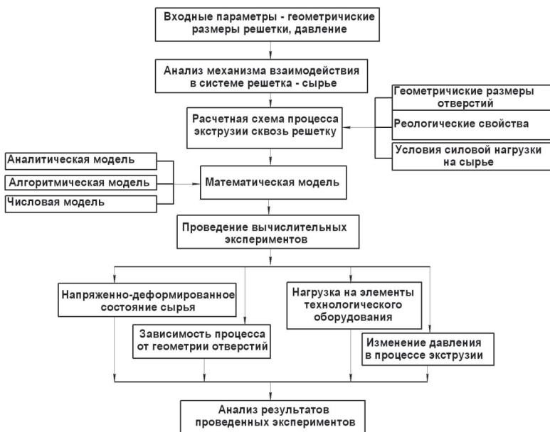
Рис. 2. Схема определения рациональных конструктивно-технологических параметров формовочной решетки.
