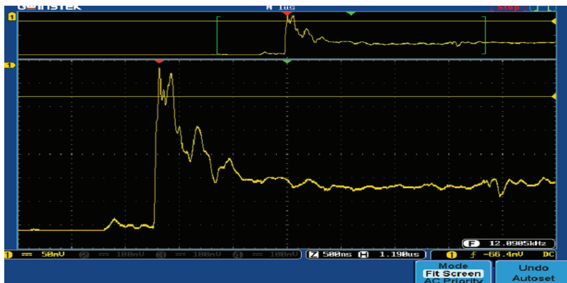
Фиг.8 Ток на възбуждане при преходен процес с електронен регулатор 5 пъти по кратък във времето
