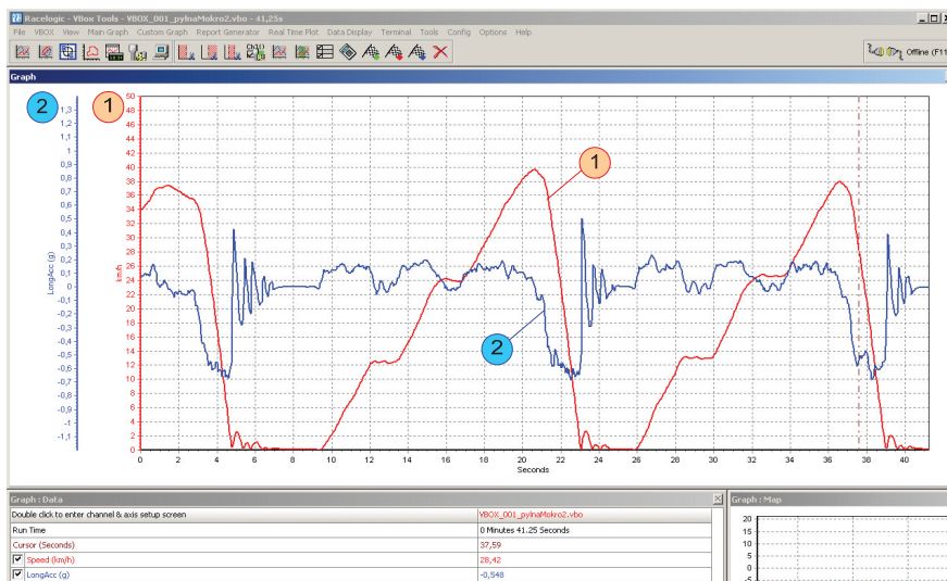
Фиг. 3. Работен екран на софтуера VBOX Tools: 1 - изменение на скоростта; 2 - изменение на ускорението
