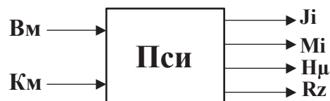
Фиг.1 Модел за изследване процеса на сработване на триещи се повърхности при плъзгане: Вм, Км са вид на модификатора, концентрация на модификатора. Ji, Mi, Hμ, Rz - вектори на параметрите на износването, моментите на триене, твърдостта и грапавостта на триещата се повърхност.
