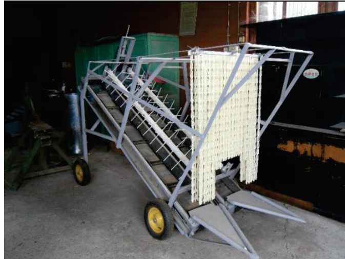
Фиг.5 Експериментален стенд за прибиране на сусам на кутийки
