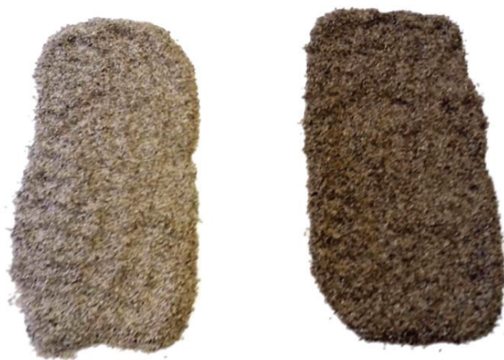
Фиг.8 Овършани семена с разработения стенд (в ляво) и със зърнокомбайн Winterstreiger (в дясно) и почистени със зърночистачна машина CM - 0,15
