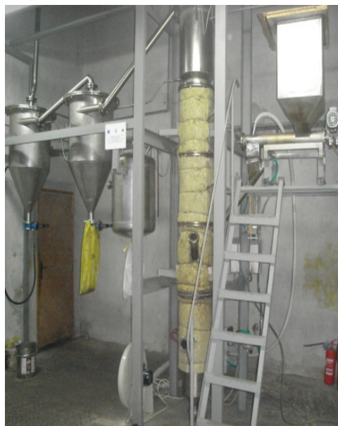
Фиг. 1 Полупромишлена инсталация за пиролиз на оризови люспи с реактор тип „кипящ” слой
