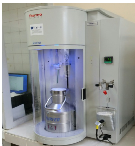
Фиг.2 Адсорбционен поризиметър Surfer на фирма Thermo Scientific
