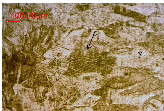
Фиг. 7 Микроструктура на стоманата със степен на деформация 36%
