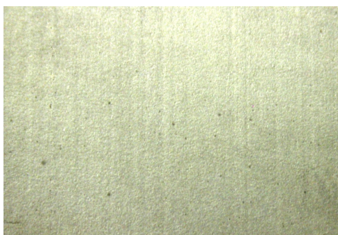
Фиг.1 Повърхност на стоманата, деформирана до 18%, след престой от 163 h в агресивната среда без D-Panthenol 75%W
