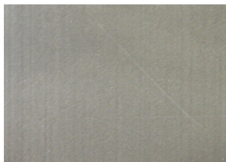
Фиг.2 Повърхност на стоманата, деформирана до 18% след престой от 163 h в агресивната среда с 0,75 g/l D-Panthenol 75%W
