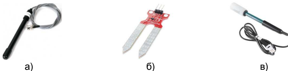
Фиг.1. Безжични сензори за измерване на основни параметри на почва: а) електропроводимост, б) влажност, в) киселинност.
