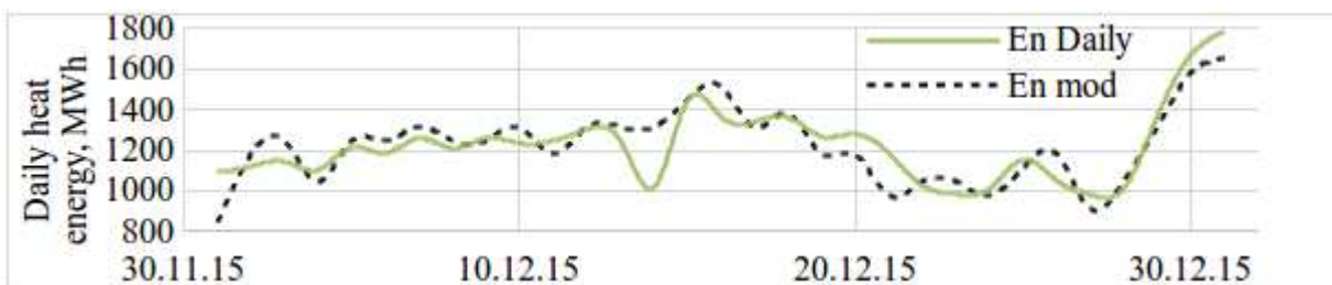
Фиг. 12. Реална и моделирана консумация на топлинна енергия през Декември.
