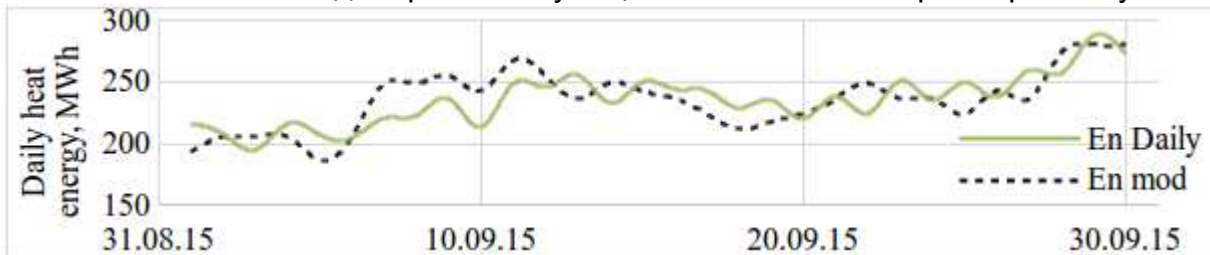
Фиг. 9. Реална и моделирана консумация на топлинна енергия през Септември.
